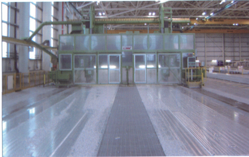
图1 空客A380超长机翼壁板加工设备
